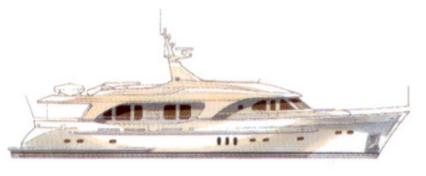
den Verkauf einer zweiten 97'. Der von René van der Velden konzipierte und Diana Yacht Design konstruierte Rundspant Verdränger mit Stahlrumpf und Aluaufbauten basiert auf der Moonen 96' *Clementine* mit Details der erfolgreichen Moonen 84'. Zwei Caterpillar-Diesel sollen für eine Max-Fahrt von 13 kn sorgen.
